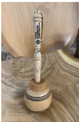
Frêne tourné sur un mandrin à stylo. Finition à base d'un mélange maison. Gravure au laser.
