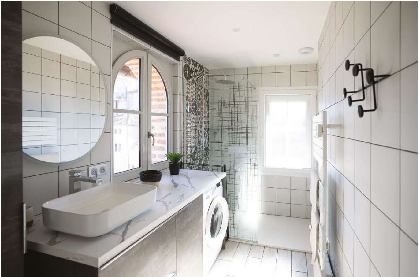
Salle de douche carrelée. Meuble vasque avec comptoir en marbre stratifié. Dans la cabine de douche, patchwork de carreaux de ciment noirs et blancs.
